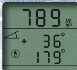
Solare Einstrahlung, Neigungswinkel und Kompasspeilung
