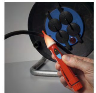
Prüfung auf Kabelbruch
