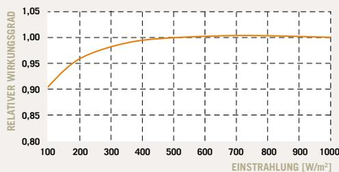
Die typische Änderung des Modulwirkungsgrades bei einer Einstrahlung von 200 W/m<sup>2</sup> im Verhältnis zu 1000 W/m<sup>2</sup> beträgt -4 % (relativ) (bei 25 °C, AM 1,5 Spektrum).
